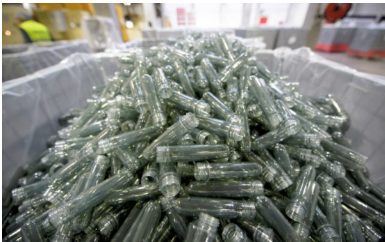
Dans son usine de Grigny (Essonne), Coca-Cola fabrique des préformes pour les bouteilles à partir de granulés de plastique recyclé.
